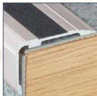
Se pose sur marches peintes ou recouvertes de carrelage, parquet collé, revêtement plastique. Utilise des bandes carborundum d'épaisseur 1 mm et de largeur 19 mm.
