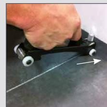
Guide lame métallique parfaitement centré par rapport à la lame et la roulette arrière.
