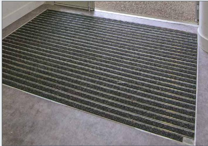
La gamme ROMAT est constituée de profilés en ALU BRUT dans lesquels viennent s'insérer des bandes de moquette (certaines avec classement feu) et caoutchouc anti-salissure spécialement étudiées. Les profilés sont reliés entre eux par des bandes d'assemblage en PVC souple placées sous les profilés, amortissant les bruits d'impact du trafic et permettant l'enroulage du tapis. **Épaisseur des profilés : 1,5 mm.**
